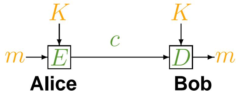
clé de chiffrement = clé de déchiffrement ( $K = K'$ )
