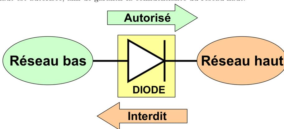
Cet article présente le projet Diode réseau du CELAR, qui a pour but de montrer qu'il est possible de mettre en place une liaison diode à l'aide de matériel standard avec un coût d'acquisition faible, tout en apportant un niveau de confiance élevé.
