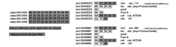
FIGURE 8. Application du masque d'intégrité sur les fonctions ZwAllocateVirtualMemory et ZwProtectVirtualMemory. Les valeurs qui doivent être identiques sont en gris clair.
