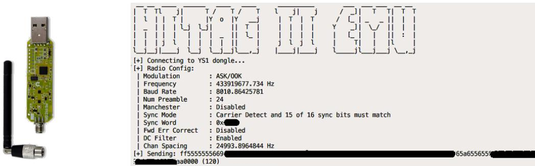
Fig. 11. YARD Stick One et simulateur de clé logiciel
