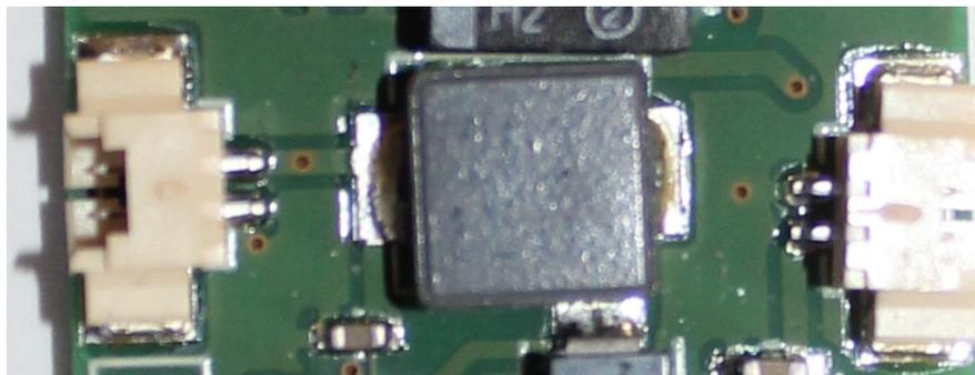
**Fig. 3.** Pistes larges pour le circuit d'alimentation
