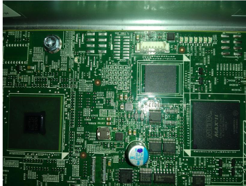
FIGURE 14 – CPLD à côté du CPU de l'iDRAC
