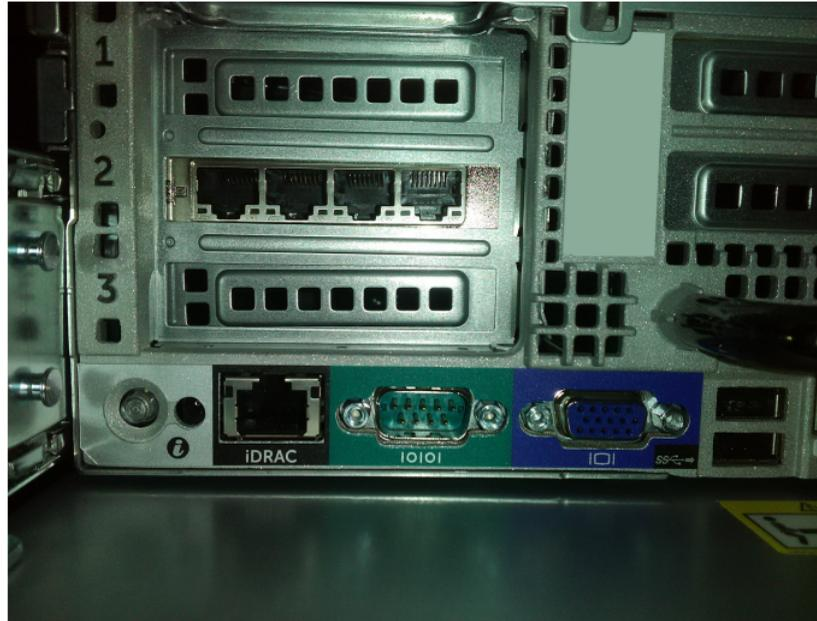
FIGURE 3 – Ports d'un serveur Dell PowerEdge R730
