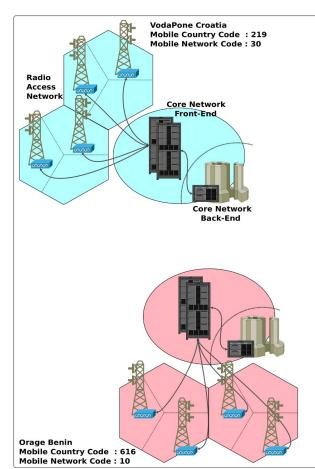
Connexion d'un abonné sur son réseau d'origine : RAN et CN FE, puis CN FE et BE
