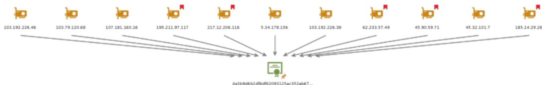
Figure – Schéma partiel de infrastructure identifiée grâce au certificat TLS. Les nouveaux serveurs identifiés ont été tagués en rouge.
