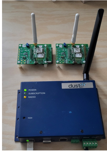
Fig. 6. Matériel ( gateway et nœuds) WirelessHART utilisé lors de nos expériences
